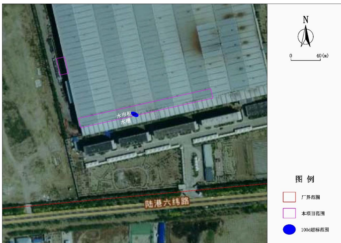
图 5.4-5 发生泄漏后地下水中二甲苯超标范围示意图
